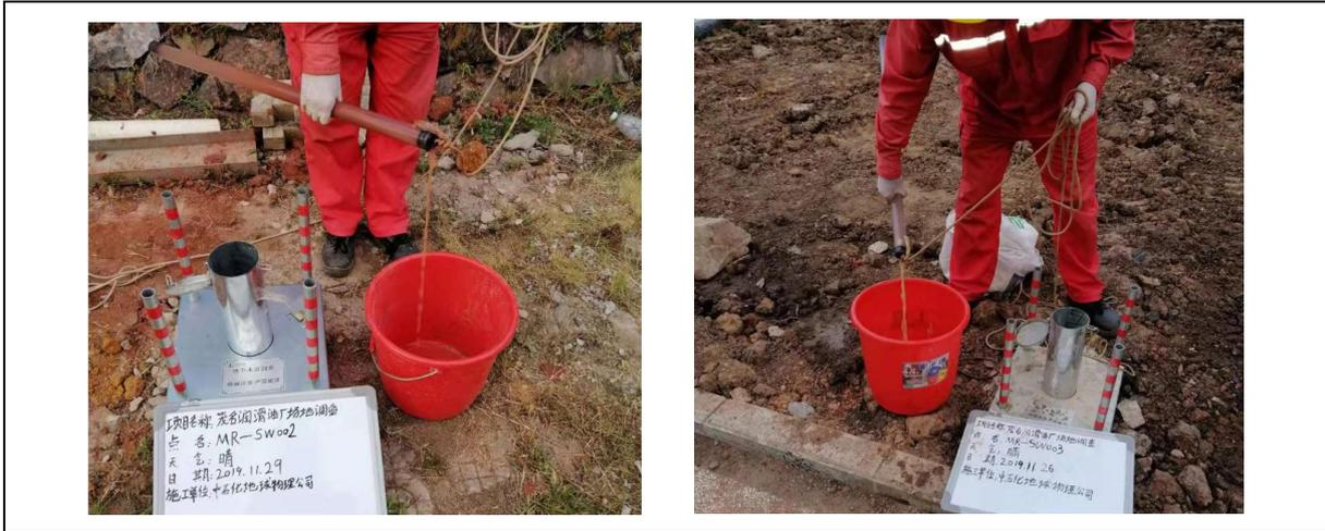
图 6-4 地下水监测井洗井照片
