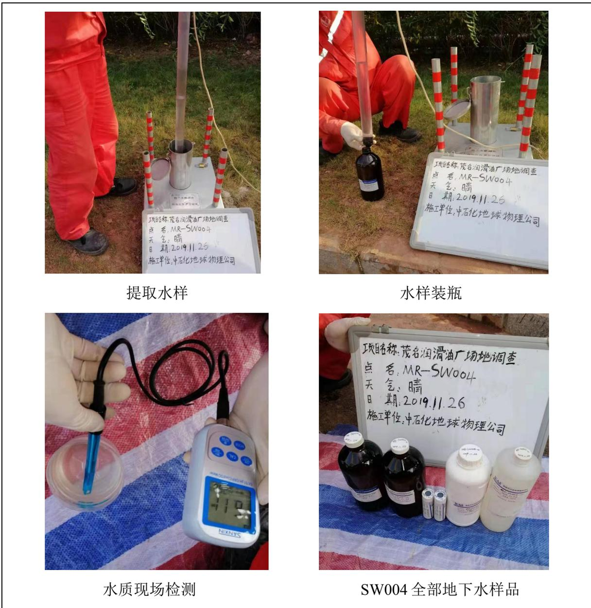
图 6-5 地下水采样关键环节现场照片
