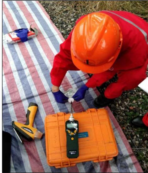
图 5-6 PID 现场检测
