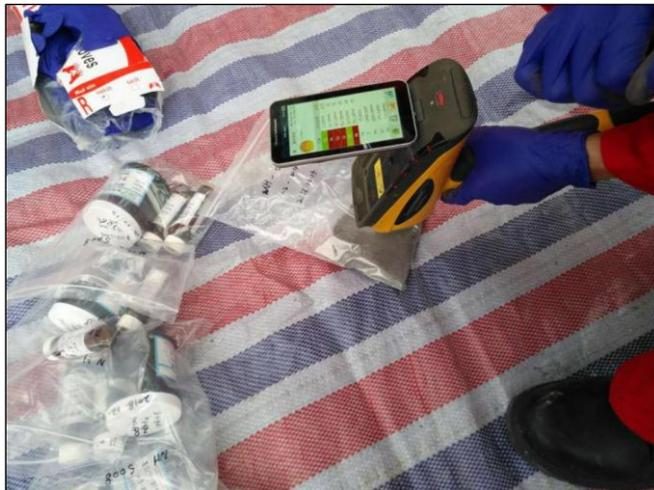
图 5-5 XRF 现场检测
