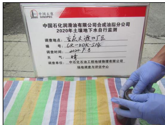
CR-DDK-S14 SVOCs 及 TPH 样品采集和装瓶
