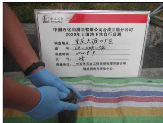
CR-DDK-S4 SVOCs 及 TPH 样品采集和装瓶
