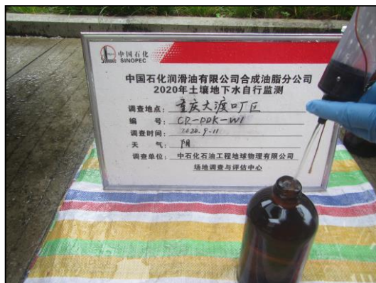
CR-DDK-W1-SVOCs 和 TPH 水样装瓶
