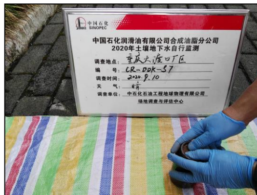
CR-DDK-S7 SVOCs 及 TPH 样品采集和装瓶
