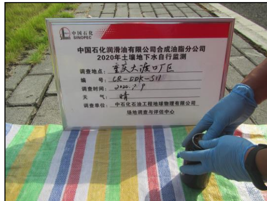
CR-DDK-S11 SVOCs 及 TPH 样品采集和装瓶
